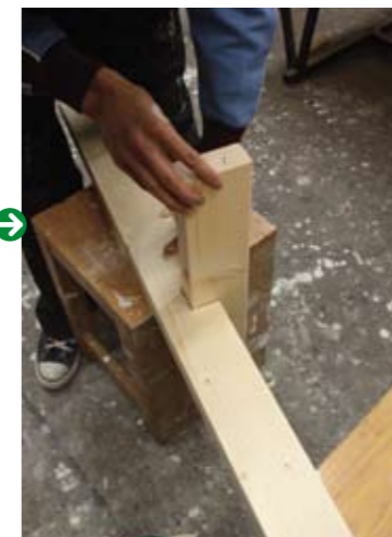
棚板を接合する部分のひっかかりを作ります。一つ一つの木材をドリルで切り、最後はカンナで仕上げ。こんな一つ一つの作業も全て手作業です。
