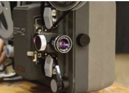
細いフィルムがみえますか？ このフィルムがまわり、光があてられて、レンズから投射されるのです。
