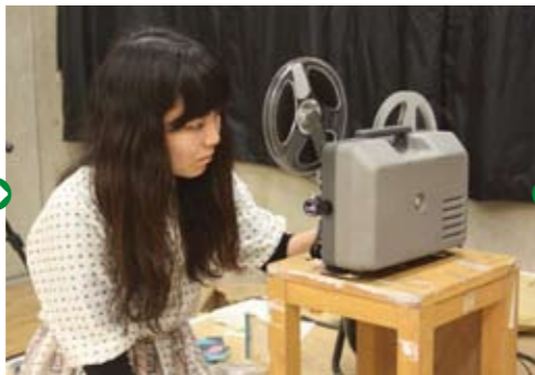
8ミリ映写機を調整しています。コンピューターで編集するには、この8ミリフィルムから映像を流し、それをデジタルビデオカメラで再撮影するのです。
