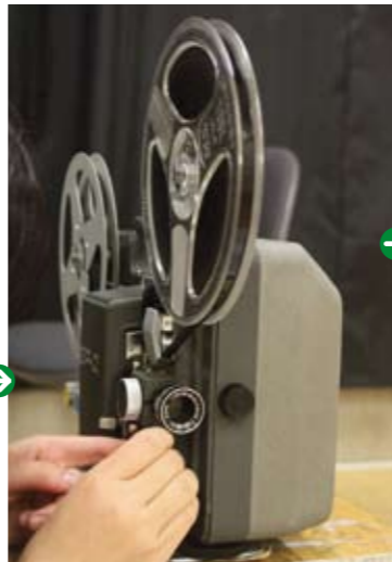
8ミリ映写機を調整しています。コンピューターで編集するには、この8ミリフィルムから映像を流し、それをデジタルビデオカメラで再撮影するのです。
